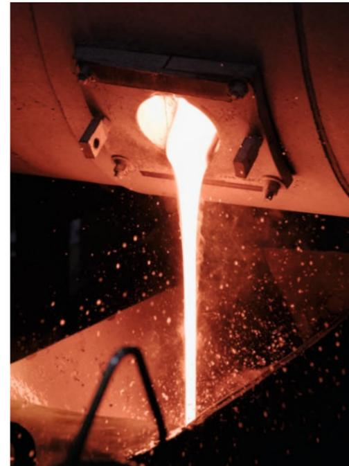
Bei 1500 Grad entsteht aus Zutaten wie Quarz, Borax und anderen flüssige Emaile, die dann in mehreren Schritten sprühfähig wird.
