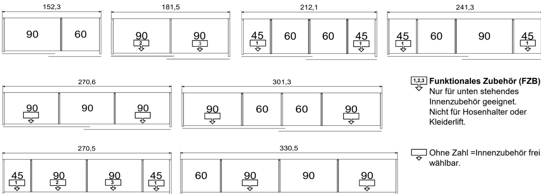
Innenschubkästen für Schwebetüren, müssen mit einer Blende L/R ausgestattet sein, damit sie bei aufgeschobener Tür zu öffnen sind.
