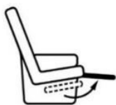
Ausschwenkbares Fußteil manuell verstellbar
