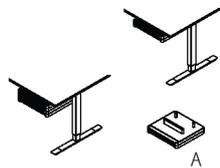
Rollcontainer 3 Schubkästen in Korpus- und Frontausführung Materialschale, auf dem Schubkasten verschiebbar, Breite einstellbar
