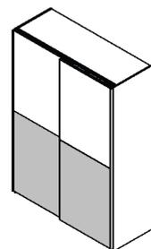
Die Frontseiten am Schwebetürenschränk 031 bestehen aus 4 gleichgroßen Elementen, die auch diagonal versetzt montiert werden können.
