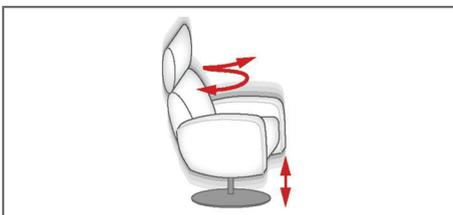
Mittels der höhenverstellbaren Drehspindel lässt sich die Sitzhöhe von 43 – 47 cm variabel einstellen. Durch die Auswahl der HVS entfällt die Standardsitzhöhe.
