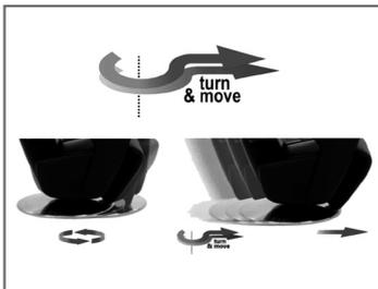
Schieben einfach gemacht. Durch integrierte Rollen im Drehteller lässt sich der Drehsessel einfach verschieben. Funktion darf nur zum Schieben des Sessels genutzt werden.
