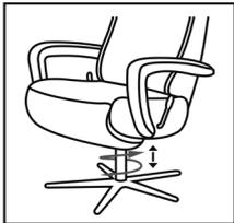
Mittels der höhenverstellbaren Drehspindel lassen sich die Ergonomie Größen small, medium und large in der Sitzhöhe von 43 bis 47 cm variabel einstellen.
