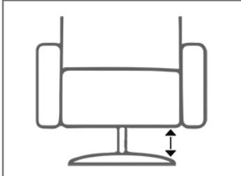
Mittels des innenliegenden Hebels lässt sich per Gasdruckfeder die Sitzhöhe von 45 bis 49 cm variabel einstellen.
