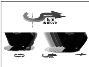
Schieben einfach gemacht. Durch integrierte Rollen im Drehteller lässt sich der Drehsessel einfach verschieben. Funktion darf nur zum Schieben des Sessels genutzt werden.
