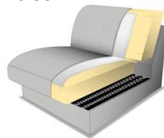
PUR-Schaum auf Wellenfedern (Standard)
