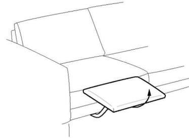
Wahlweise bei den gekennzeichneten Modelltypen links und/oder rechts möglich. Die Beinauflage wird unter dem Vorderboden platziert und kann durch Touch-Buttons ausgelöst und arretiert werden.
