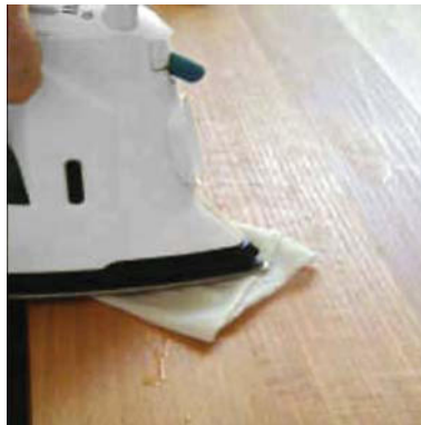
feuchtes Baumwolltuch unter das Bügeleisen legen
