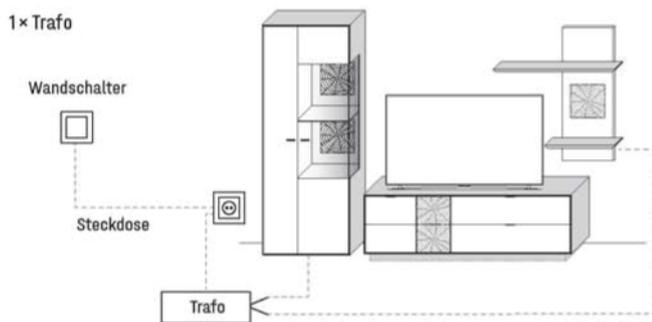
Bitte am Ende Ihrer Planung die Gesamtwattzahl ermitteln und den/die entsprechende(n) LED-Trafo(s) sowie die gewünschte Schaltervariante(n) definieren. Optional kann der Schalter durch einen Funkdimmer ersetzt werden, sodass Sie die Beleuchtung per Fernbedienung bequem vom Sofa aus steuern können. Diesbezüglich sollte dem Auftrag unbedingt eine Planungsskizze hinzugefügt werden.
