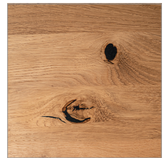
▲ Wildeiche (W) geschlossene Äste mit schwarzem Kitt Rustical oak (W) closed knots with black filler
