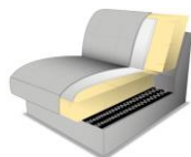
PUR-Schaum auf Wellenfedern (Standard)
