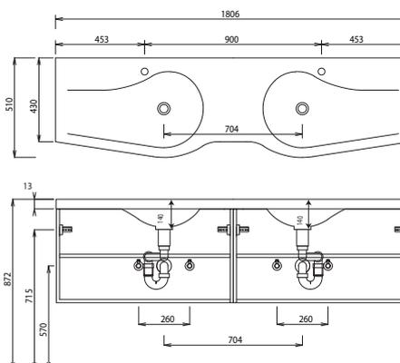
Bei Waschtischanlagen mit Befestigungsschrauben müssen die Maße zum Bohren vor Ort, nach dem Auflegen des Waschtisches auf den Unterschrank, angezeichnet werden.
