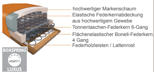
Boxspringsitz mit Bonell-Federkern und Tonnentaschenfederkern
