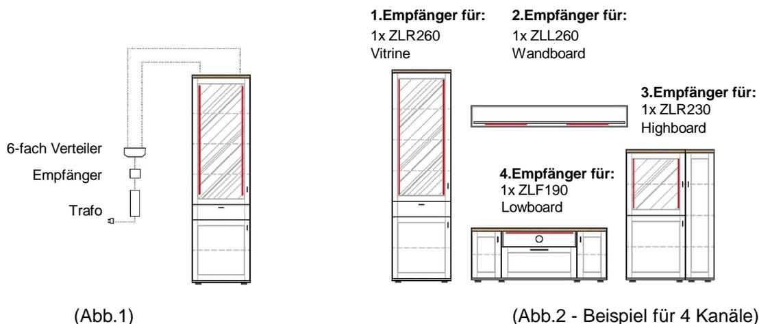
Die Montage des Empfängers erfolgt bei jedem Set immer zwischen Trafo und 6-fach Verteiler. (Abb.1)
