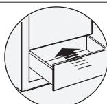
Schubkästen mit Selbsteinzug und Dämpfung
