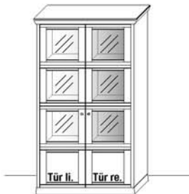
B 125,0 x H 207,0 x T 44,0 cm 4 Glas-Einlegeböden / 2 feste Holzböden / 2 Holz-Einlegeböden / 10 Fächer
