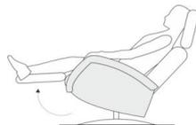
Durch bewegen des Bedienhebels nach hinten kann der Rücken durch leichten Körperdruck stufenlos bis zur Liegeposition verstellt werden.
