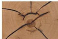
Hirnholz-Scheibe massiv, rissig
