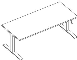
T-Fuß-Gestell mit manueller Höhenverstellung mittels Kurbel
