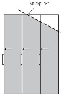
Eine seitliche Abschrägung ist **nur an Elementen mit 1 Drehtür bzw. 1 Falлтürenpaar** möglich. Der Türanschlag muss immer an der höher verbleibenden Seite liegen.
