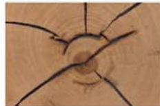
Hirnholz-Scheibe massiv, rissig
