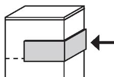
Seitliche Applikation kann bei Anbau-kombinationen entfernt werden. Nicht möglich bei Type 675/356.
