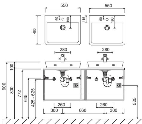
Bei Waschtischanlagen mit Befestigungskonsolen müssen die Maße zum Bohren vor Ort, nach dem Auflegen des Waschtisches auf den Unterschrank, angezeichnet werden.
