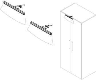
2 LED-Oberbodenleuchten in Aluminium, werden auf Oberboden aufgesetzt montiert.
