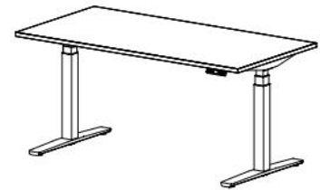
T-Fuß-Gestell mit elektromotorischer Höhenverstellung, mit Schnellverschlussystem (eUP3 PRO)
