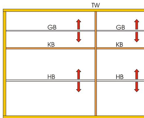
**(GB) Glasböden:** Verstellbar auf 3er Rasterbohrung im Abstand von 3cm. Auf Fachbodenträger aufliegend.
