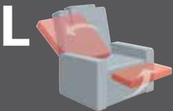
getrennte Verstellung der Rückenlehne und der Fußstütze durch Gewichtsverlagerung
