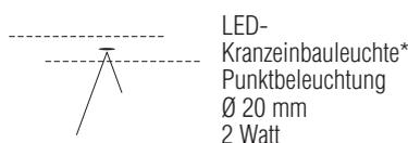
\*Dimmbare LED-Beleuchtung (E; BEL146K-Koch) mit nicht austauschbaren Leuchtmitteln, Aktivierung per Fernbedienung (2 Kanal-Fernbedienung, Lichtfarbe stufenlos einstellbar von kalt- bis warmweiß).
