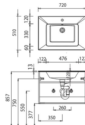
Bei Waschtischanlagen mit Befestigungsschrauben müssen die Maße zum Bohren vor Ort, nach dem Auflegen des Waschtisches auf den Unterschrank, angezeichnet werden.
