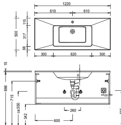
Bei Waschtischanlagen mit Befestigungsschrauben müssen die Maße zum Bohren vor Ort, nach dem Auflegen des Waschtisches auf den Unterschrank, angezeichnet werden.
