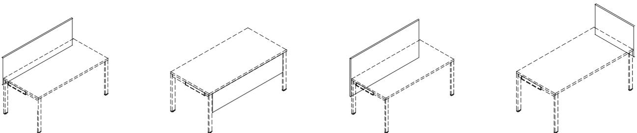
Für die Sichtschutzpaneele gibt es 8 mm starke, mit Stoff bezogene Pinnwände, die an 0,8 mm starken, alufarben gepulverten Metallplatten befestigt sind. Pinnwände sind 290 mm hoch und in den Breiten 350 mm und 700 mm erhältlich. Das Organisationspaneel besteht aus 1,5 mm starken Blech, alufarben gepulvert. Öffnungen
