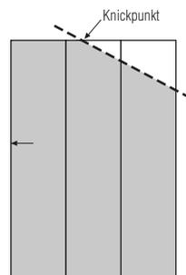
Eine seitliche Abschrägung ist **nur an 1-türigen Elementen** möglich. Der Türanschlag muss immer an der höher verbleibenden Seite liegen.
