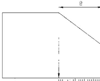
3. Wenn der Knickpunkt aufgrund der Rundung nicht feststeht, mehrere Hilfslinien anlegen und genauen Abstand messen, siehe Abb. rechts.
