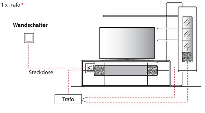
Die Beleuchtung wird mit einer ausreichenden Anzahl an Trafos, inklusive einem Schalter, geliefert. Optional kann der Schalter durch einen Funkdimmer ersetzt werden, sodass Sie die Beleuchtung per Fernbedienung bequem vom Sofa aus steuern können. Diesbezüglich sollte dem Auftrag unbedingt eine Planungsskizze hinzugefügt werden.
