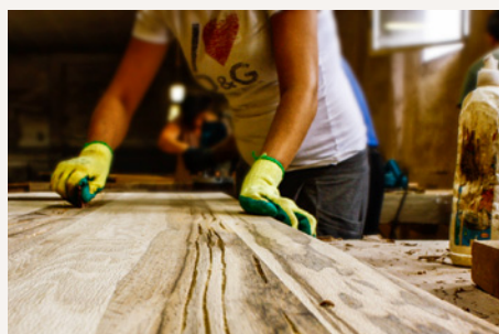
Schleifen eines zuvor ausgearbeiteten Risses
