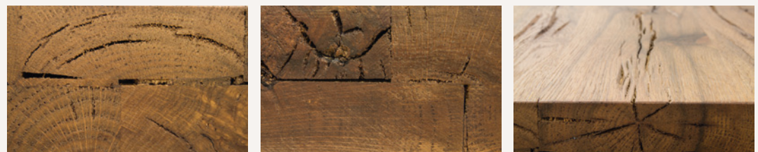
Merkmale der Stirnseiten der Deckplatten
