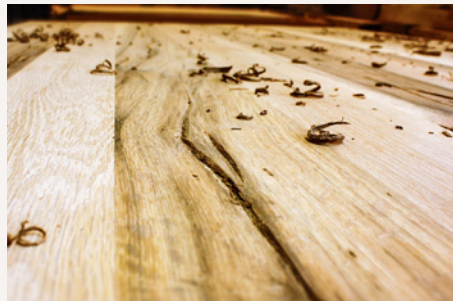
Grob ausgearbeitete Risse
