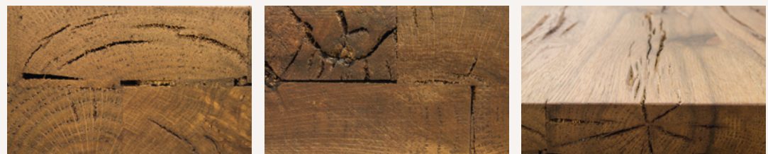
Merkmale der Stirnseiten der Deckplatten
