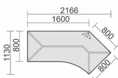
Schreibtisch 135° rechts mit Bodenausgleichsschrauben, höhenverstellbar
