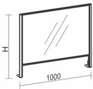
Hygienewand zum Aufschrauben auf Thekenaufsatz oder Tischplatte Aluminium-Rahmengestell, Scheibe aus 6mm starken Acrylglas Durchreichemöglichkeit unter dem Acrylglas
