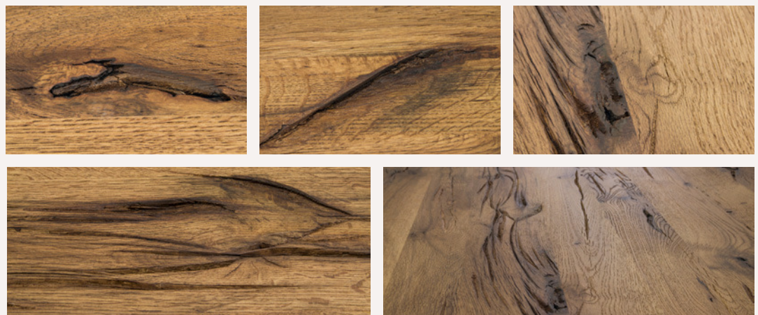
Merkmale in der Fläche der Deckplatten
