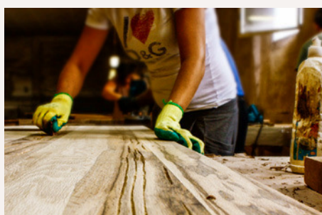
Schleifen eines zuvor ausgearbeiteten Risses
