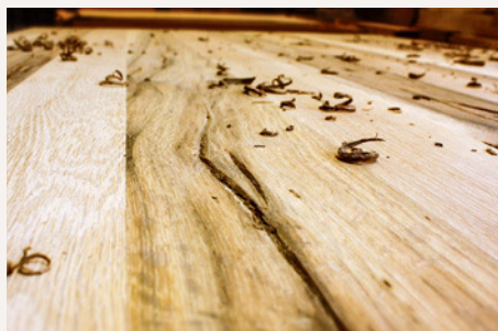
Grob ausgearbeitete Risse
