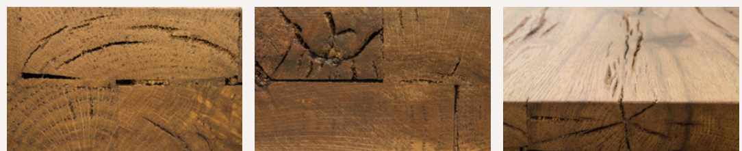
Merkmale der Stirnseiten der Deckplatten
