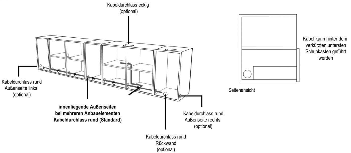
Die Verkabelung der Geräte erfolgt im hinteren unteren Korpusbereich. Standardmäßig befindet sich hinter einer Lochblechklappe ein Kabeldurchlass rund.
