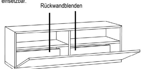
Die Verkabelung der Geräte kann von vorne mit magnetisch befestigten Blenden verdeckt werden.
