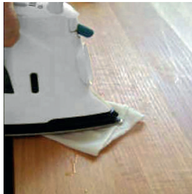
feuchtes Baumwolltuch unter das Bügeleisen legen
