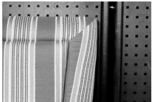
Bsp. 2: Kopfteil mit seitlicher Gehrungsnah; keine rapportgerechte Verarbeitung möglich.
