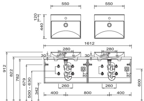
Bei Waschtischanlagen mit Befestigungsschrauben müssen die Maße zum Bohren vor Ort, nach dem Auflegen des Waschtisches auf den Unterschrank, angezeichnet werden.
