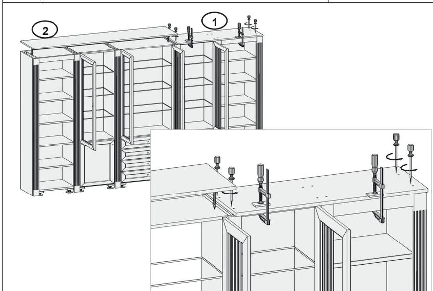
Bei mehreren Deckplatten beginnen Sie mit der Montage in der Mitte (1). So können Toleranzen nach außen ausgeglichen werden. Legen Sie die Platten mittig auf den Schrank und verschrauben Sie diese von oben durch die Platte mit den Schrauben 3,5 x 30mm. Legen Sie nun die restlichen Platten links bzw. rechts auf den Schrank (2). Zum Schluss kleben Sie die Abdeckkappen auf die Schraubenköpfe.
