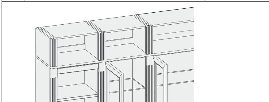
Montieren Sie alle weiteren Aufsätze, wie in Punkt C.12 beschrieben. Nun können Sie den Kranz montieren (siehe Punkt L, Montage des Kranzprofil)
