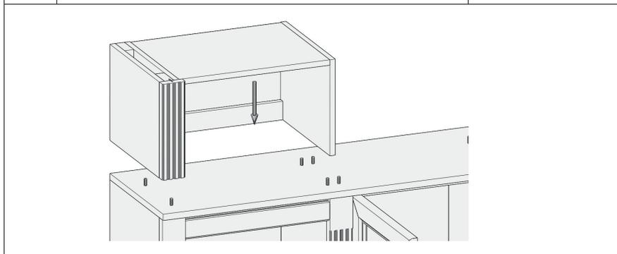
Stecken Sie von oben in die vier 8mm Bohrungen der Deckplatte des montierten Standkorpus je einen Holzdübel Ø8x30mm. Stellen Sie den Aufsatzkorpus von oben auf die Deckplatte, dass die Holzdübel in den unteren Schmalflächen der Aufsatzseiten stecken.
