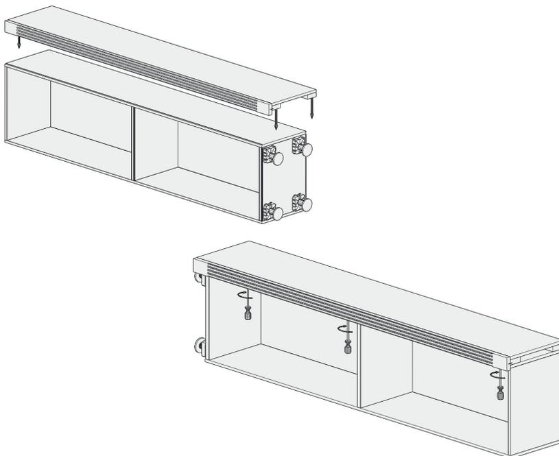
Legen Sie den Schrank auf die Seite und befestigen Sie die Blendseite wie bereits in Punkt C.11 beschrieben.
