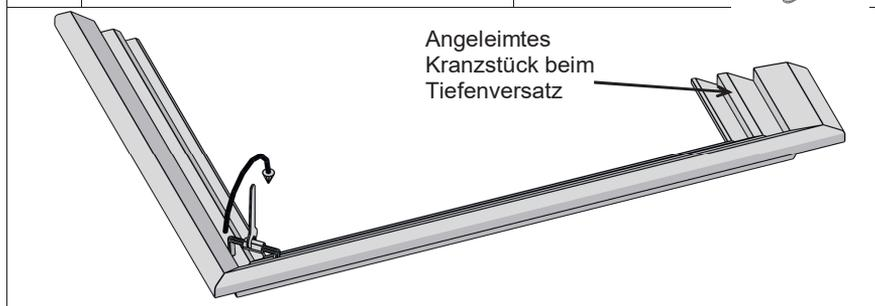
Beginnen Sie mit der Montage des Kranzes bei den Elementen mit der 30er-Korpusstiefe. Sollte sich ein Rücklauf daran befinden, verbinden Sie die beiden Elemente vor dem Aufstecken mittels eines Kranzverbinders.
