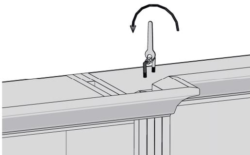
Sollten es die Platzverhältnisse in der Höhe zulassen, können Sie den Kranzverbinder nutzen, um die Gehrung dicht zu schließen.
