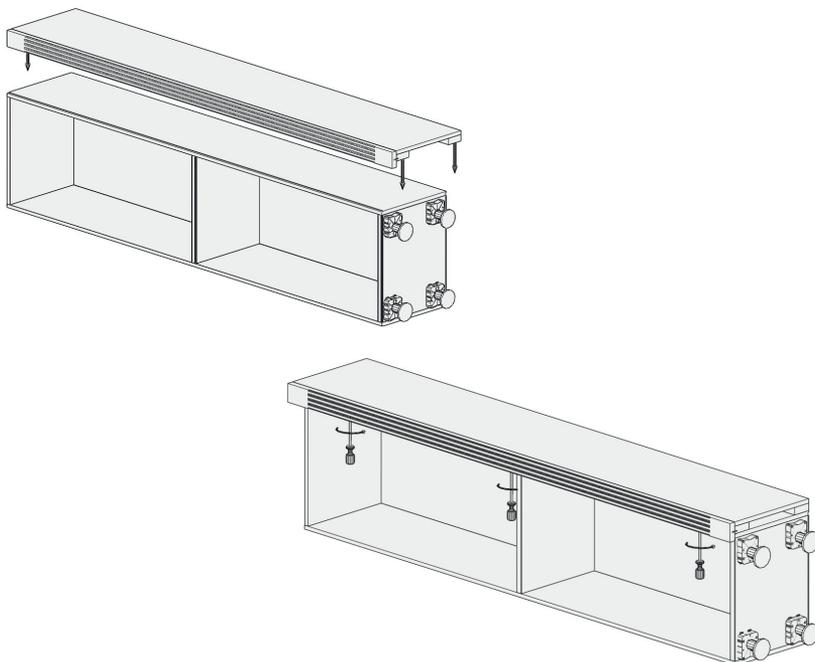
Legen Sie den Schrank auf die Seite und befestigen Sie die Blendseiten rechts wie bereits in Punkt C.11 beschrieben. Wiederholen Sie diesen Vorgang bei dem Eckschrank.
