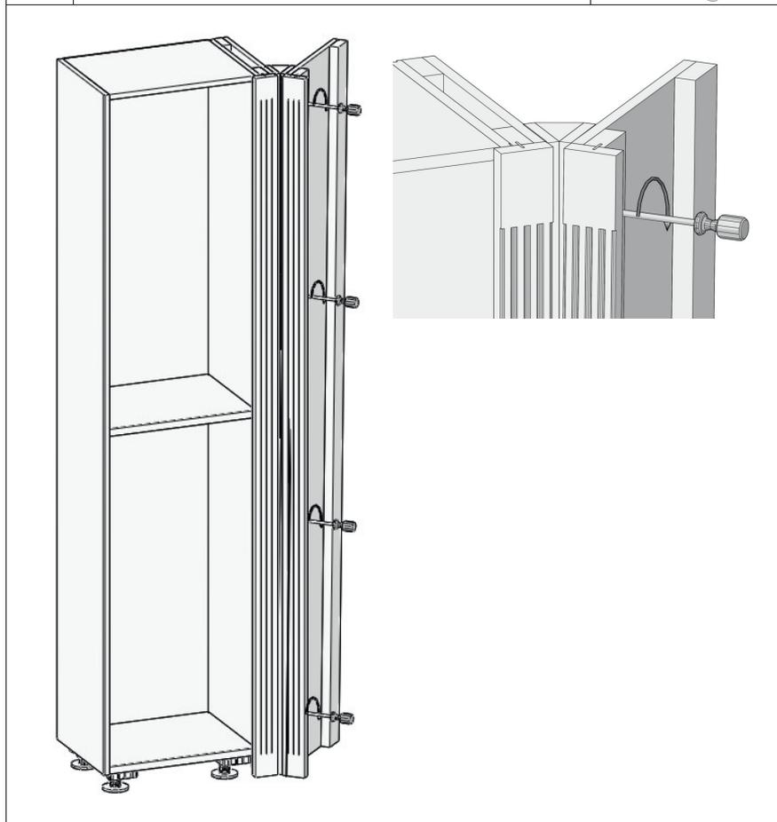
Stellen Sie nun den Schrank mit der montierten Winkelleiste auf die FüÙe. Und richten Sie diesen aus, wie bereits in Punkt...beschrieben. Stellen Sie die nächste Blendseite mit der Markierungsnut an die Winkelleiste. Befestigen Sie diese mit den Schrauben 4x55mm.
