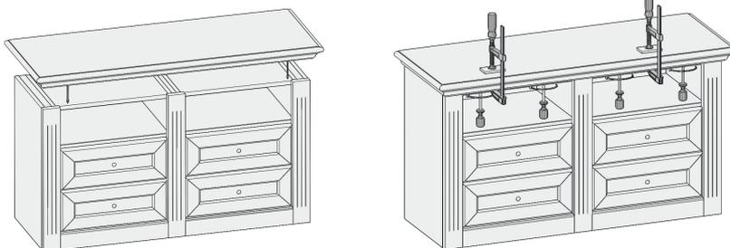
Platten finden Sie auf Möbeln bis zu einer Höhe von 10 Rastern. Legen Sie die Platte je nach Korpusstyp auf den Schrank und verschrauben Sie diese von unten durch den Oberboden mit den Schrauben 3,5x30mm.
