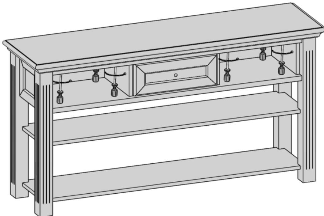
Legen Sie die Platte auf das Gestell und vermitteln Sie die Platte so, dass seitlich der gleiche Überstand ist. An der Hinterkante liegt die Platte bündig. Jetzt verschrauben Sie die Deckplatte mit den mitgelieferten Schrauben 4x50mm.
