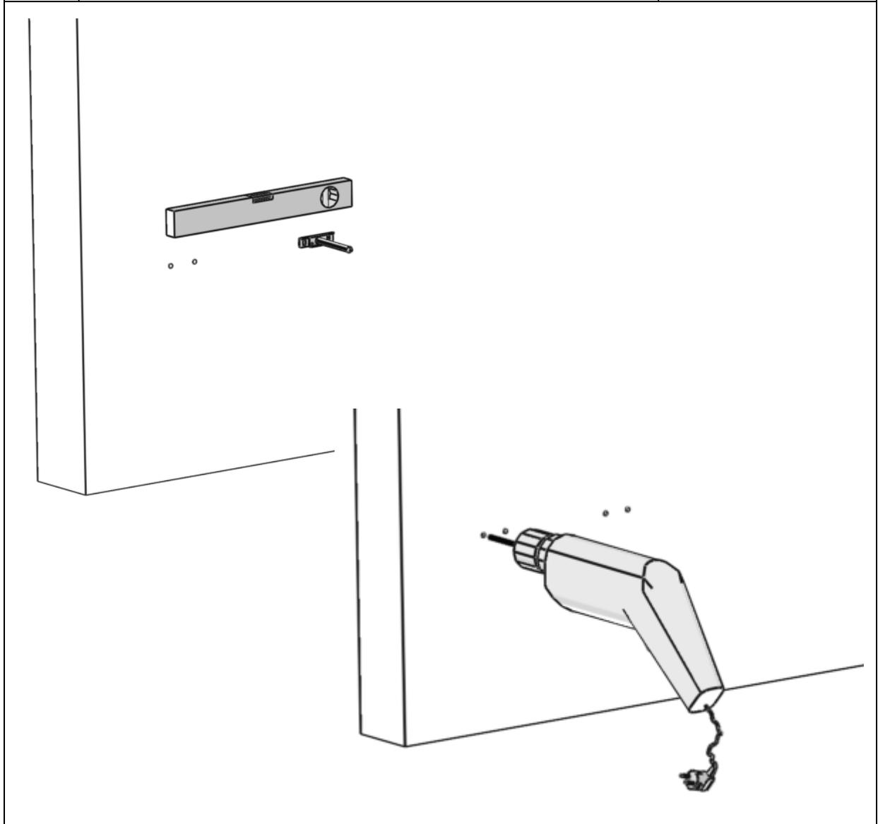
Reißen Sie die Bohrungen für die Wandaufnahmen waagrecht in den entsprechenden Abständen von den Außenmaßen an. Bohren Sie danach die Löcher für die mitgelieferten Dübel in die Wand.
