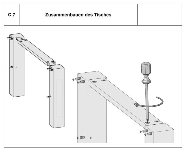
Sie haben nun alle Beschläge montiert und können nun den Tisch zusammenbauen. Stecken Sie die Querstrebe mit den Füßen zusammen und Schließen Sie die Excentergehäuse.
