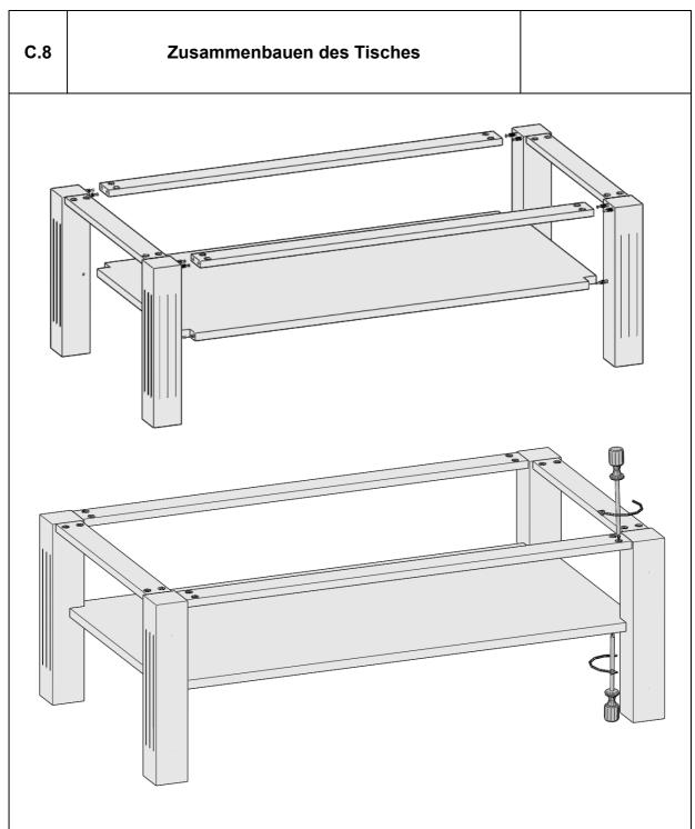
Nun stecken Sie die beiden restlichen Querstreben und den Boden mit den Füßen zusammen und Schließen Sie die Excentergehäuse.
