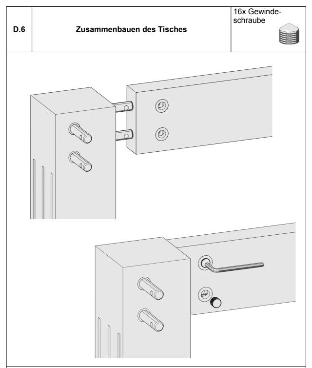
Sie haben nun alle Beschläge montiert und können den Tisch zusammenbauen. Stecken Sie die Zarge mit den Füßen zusammen und Drehen Sie die Gewindeschraube mit einem Inmbusschlüssel in das Gehäuse.
