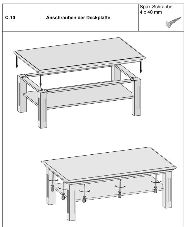
Legen Sie die Tischplatte auf das montierte Gestell und achten Sie darauf, dass die Platte nach allen Seiten den gleichen Überstand hat.
