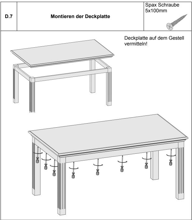
Das Tischgestell ist montiert. Jetzt verschrauben Sie die Deckplatte mit den mitgelieferten Schrauben 5x 100mm. Die Löcher dafür sind bereits vorgebohrt.
